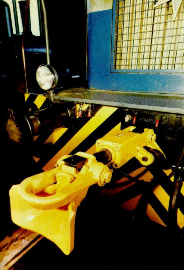
Abb. 4. Entkuppelt wird, indem der Bügel mittels Druckluft nach oben geklappt wird; zum neuerlichen Kuppeln ist die Kupplung zu entlüften.
