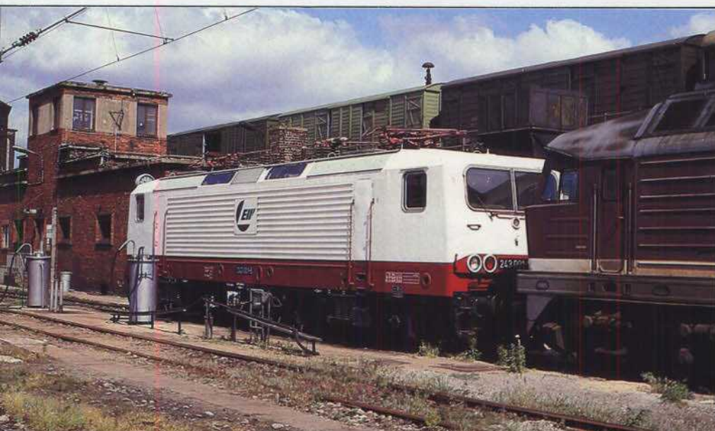
Bild 8: LEW Hennigsdorf kaufte die 243 001 im Jahre 1987 von der DR zurück, um sie als Erprobungsträger für Drehstromantriebstechnik (DAT) zu verwenden. Die Aufnahme vom 26. Mai 1990 zeigt die 243 001 in der aktuellen Lackierung im Bw Berlin Hbf. Foto: M. Krolp
