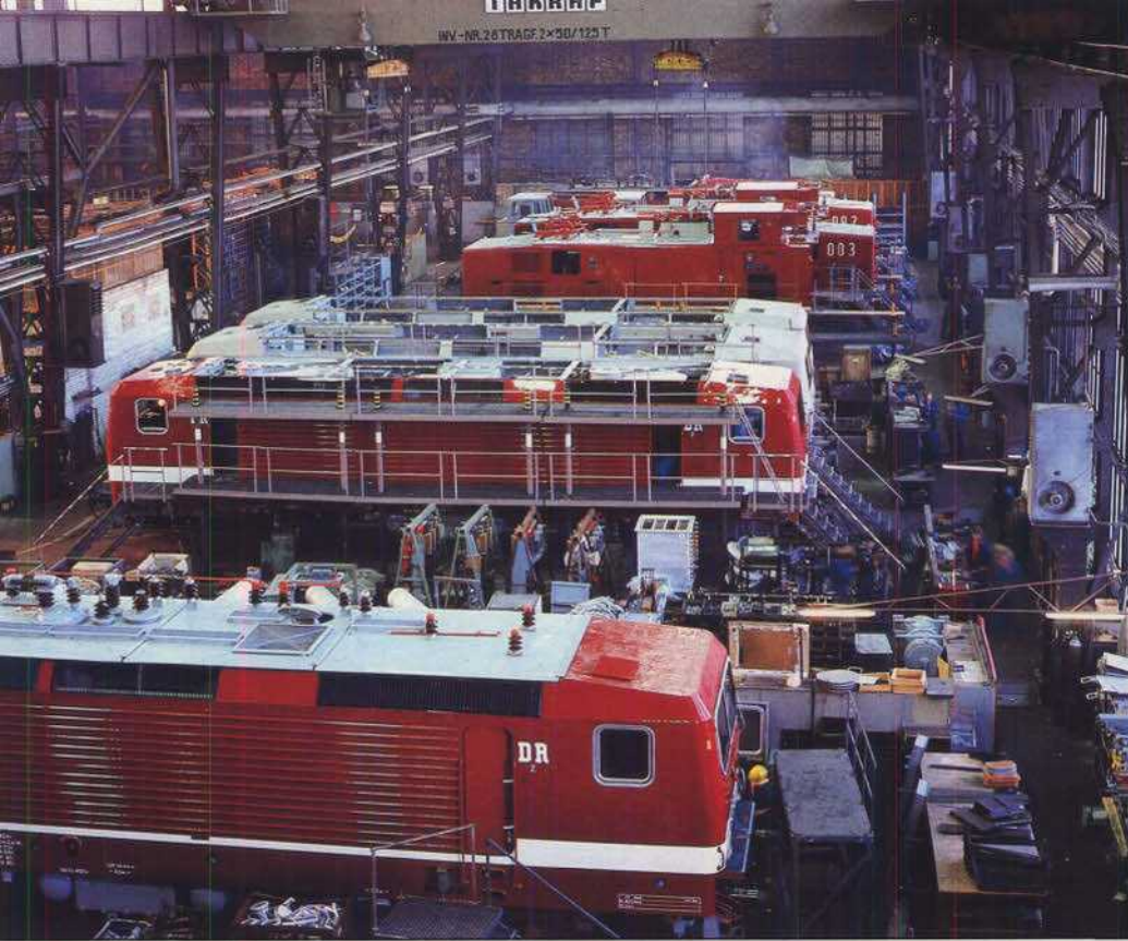
Bild 1: Blick in die Montagehalle von LEW Hennigsdorf. Betriebsnummern sind an den Lokomotiven noch nicht angebracht, doch die eckige Kopfform weist aus, daß es sich um Maschinen der Bauserien 1 bis 4 (243 002 bis 243 298) handelt. Foto: Zentrale Bildstelle der DR
