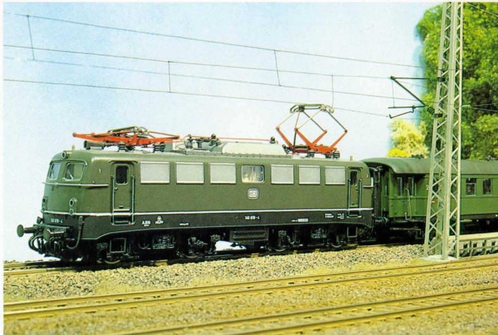
zichtet. Auf meinen Modellgleisen soll schließlich nur mit mäßiger Geschwindigkeit gefahren werden. Bei der DB ist bei der Bauform ohne Beiseil eine Höchstgeschwindigkeit von 120 km/h zugelassen. Für die Umsetzung ins Modell ist dies vollkommen ausreichend.
