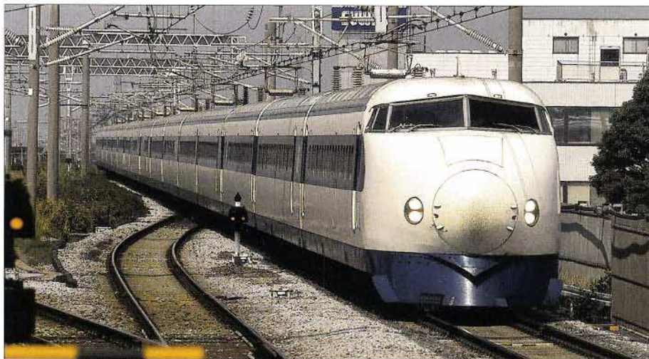
Bild 9: Ein sechzehnteiliger Zug der Baureihe 0 fährt in den Bahnhof Mishima ein. Die als äußerst zuverlässig geltende Baureihe 0 ist seit 1964 im Einsatz.
