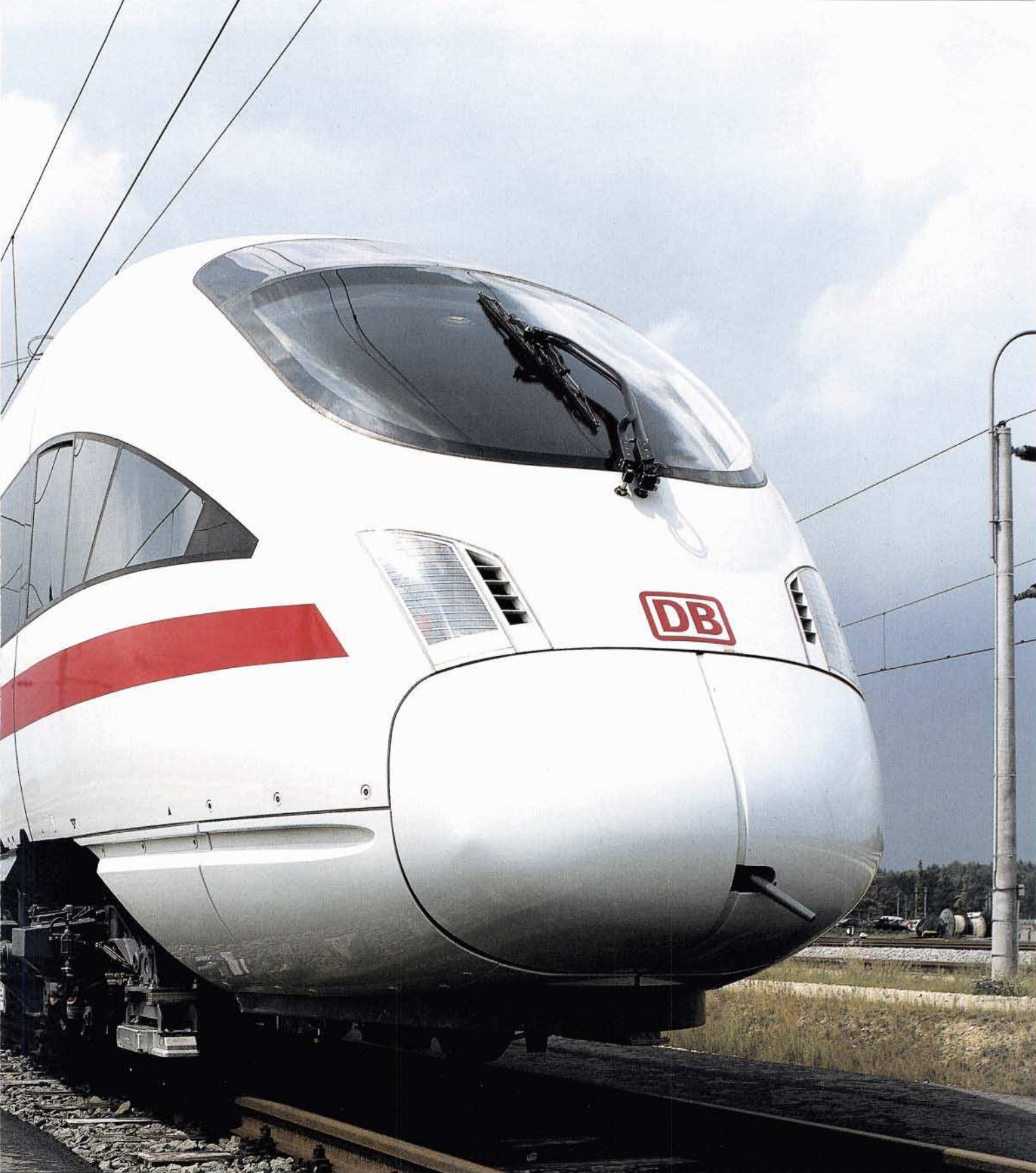
Bild 12: Mit einem neuen Design können auch ICE 3 und ICT (Foto oben im Siemens-Prüfzentrum Wegberg-Wildenrath) aufwarten. Weit bedeutender als die neue Frontgestaltung ist jedoch hier der Übergang vom Triebkopfzug- (ICE 1 und ICE 2) zum Triebwagen-Konzept. Abb.: H. Schön
