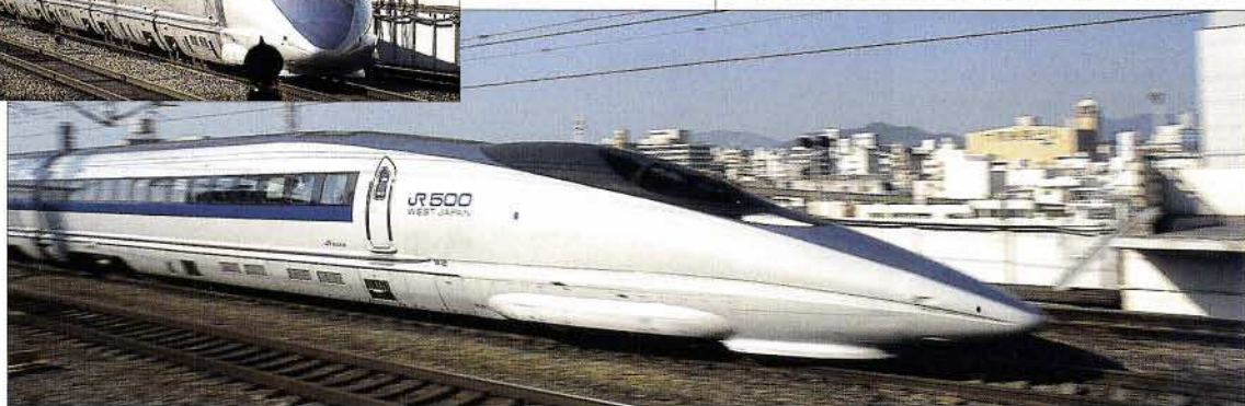
Bild 10: Ungewöhnlich ist für europäische Augen das dichte Geflecht der Oberleitungen. Im Bild oben eine in Kyoto einführende BR 500.
