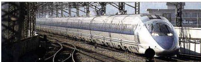
Bild 10: Ungewöhnlich ist für europäische Augen das dichte Geflecht der Oberleitungen. Im Bild oben eine in Kyoto einführende BR 500.
