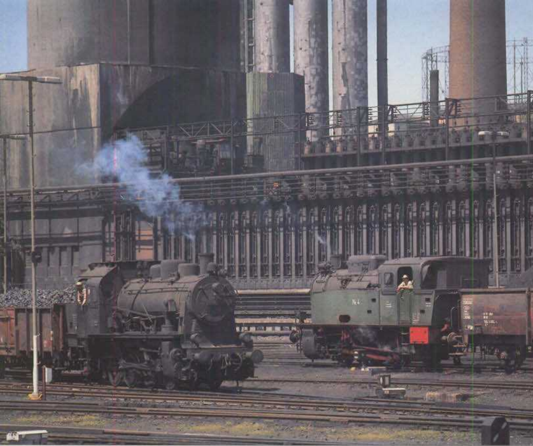
Bild 4: Während am 28. Mai 1977 die grüne Lok Nr. 4 Kohle für die Verarbeitung herbeischafft, bringt die andere Maschine fertigen Koks zur Übergabe an die DB. Neben Koks wird in den Kokereien auch Heizgas produziert, weshalb sich im Hintergrund rechts ein Gasspeicher befindet.
