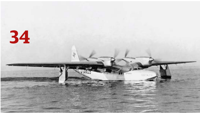
Bildschön und technisch ausgefeilt: Das viermotorige Flugboot Dornier Do 26 stand für 9000 Kilometer Reichweite
