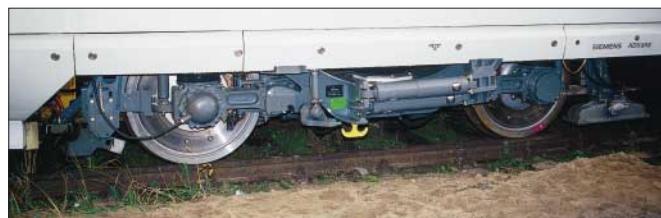
Unten: Am hinteren Ende des führenden Drehgestells liegt linksseitig der Magnet für das Schweizer Integra-System. Foto: E. Gärtner
