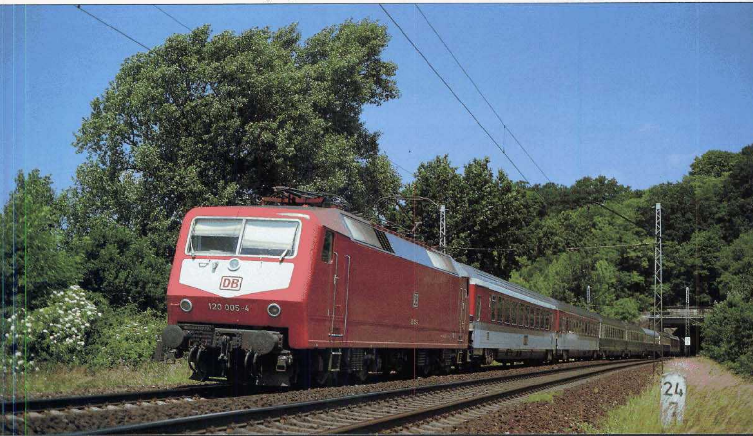
Bild 13: Von ABB Henschel mit Einzelradsteuerung ausgerüstet: 120 005 – hier mit IC 801 nach Verlassen des Erlanger Tunnels (26. Juni 1994).
