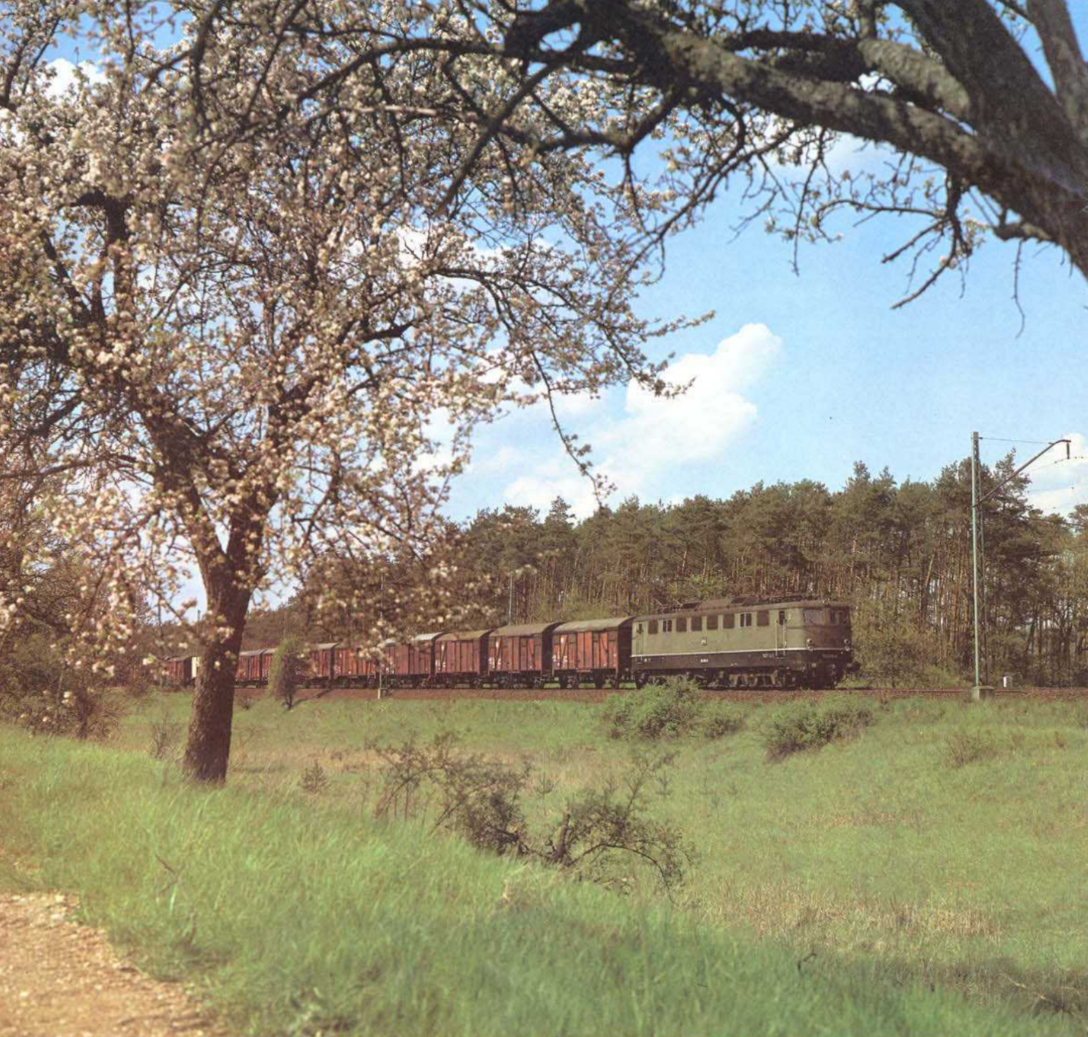
Bild 5: Im Mai 1984 befand sich die 150 095 des Bw Bebra noch weitgehend im Ursprungszustand, d. h. sie besaß noch eine umlaufende Regenrinne und abgerundete Lüfterblenden. Mit einem Güterzug von Bebra über Schweinfurt nach Nürnberg wird sie in Kürze den Bahnhof Hirschaid südöstlich von Bamberg erreichen. Foto: A Ritz
