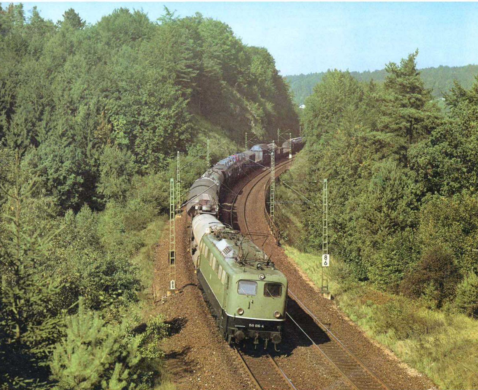
Bild 7: Die 150 016 besitzt keine umlaufende Regenrinne mehr, für den Rangierer sind statt der Griffstange unter den Führerstandsfenstern zwei einzelne Griffe montiert. Mit einem Güterzug von Nürnberg nach Passau rollt die Lok im Oktober 1983 bei Etterzhausen ins Donautal hinab.
