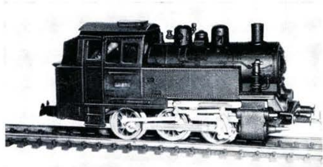
Bild 9 Ein sehr bekanntes PIKO-Modell – die BR 80 der DR, die bereits im Jahre 1954 vom VEB EIO herausgebracht wurde; für Gleichstrombetrieb; Katalog-Nr.: ME 2101
