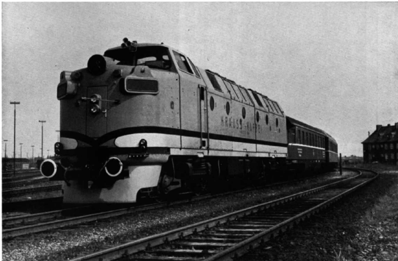
Abb. 1. Eine ML4000 – mit Puffern und Pufferbohle – auf einer Versuchsfahrt in Deutschland. Die Einwärtsneigung der oberen Seitenwandpartien ist als eine Konzession an die engeren Lichtraumprofile der europäischen Strecken zu werten, auf denen ja zunächst die einleitende Erprobung vorzunehmen war. Trotzdem sind hier die sonst üblichen Umgrenzungsmaße bereits überschritten. – Der kleinste befahrbare Krümmungshalbmesser beträgt übrigens nur 76 Meter!
