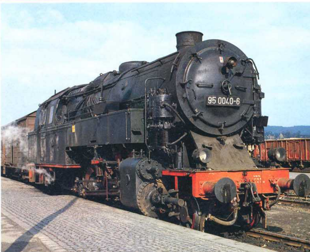
▶ Bild 7: Bemerkenswert ist das dritte Spitzenlichtsignal auf der Rauchkammer der 95 0040 – die Lampe diente ursprünglich als Triebwerkbeleuchtung.
