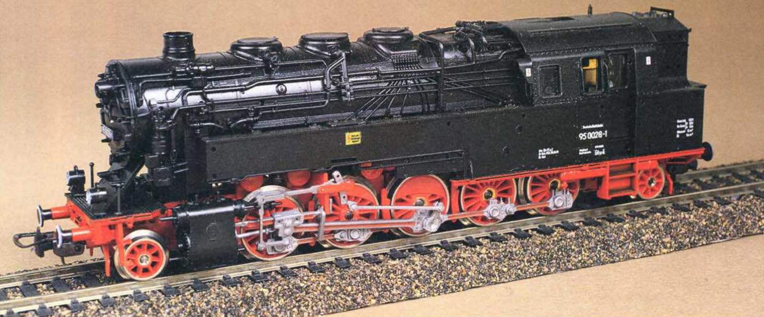
Bild 1: Das neue Modell der 95 0028, das Piko in der Baugröße H0 entwickelte. An der Lok sind die beige-packten Steckteile noch nicht angesteckt. Besonders fein und vorbildgetreu ist das Treib- und Steuerungsgestänge ausgeführt. Foto: Obermayer
