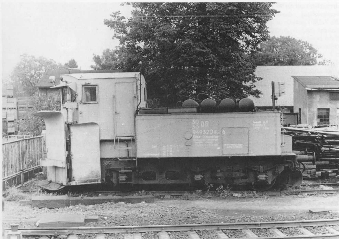
Bild 1. Seitenansicht des Klima-Schneepflugs 949 3204-6 der Deutschen Reichsbahn. Übrigens hat das Wort „Klima“ in diesem Zusammenhang nichts mit dem Wetter zu tun, sondern weist auf die Fahrzeugbauart mit beweglichen Pflugscharen hin.
