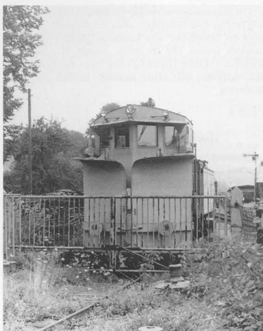
Bild 1. Seitenansicht des Klima-Schneepflugs 949 3204-6 der Deutschen Reichsbahn. Übrigens hat das Wort „Klima“ in diesem Zusammenhang nichts mit dem Wetter zu tun, sondern weist auf die Fahrzeugbauart mit beweglichen Pflugscharen hin.
