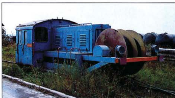
Ein Unikum des Zementwerkes Karsdorf, jedoch kein KEG-Fahrzeug: Eine Elektro-Kö mit eigenem Stromkabel.
