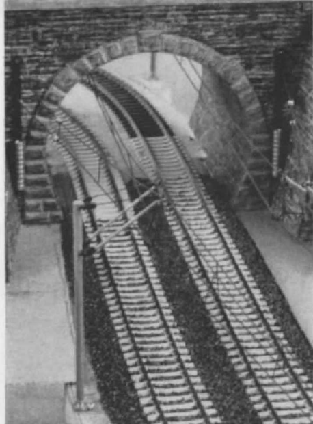
Abb. 4. Der besagte Übergang vom Peco-Betonschwellengleis zum Holzschwellengleis auf der H0-Anlage des Herrn L. Nawrocki, Schwaikheim (s. Heft 15/68), der bewußt in die Tunnelröhre verlegt worden ist (nicht Herr Nawrocki, sondern der Übergang!), so daß er nicht mehr zu sehen sein wird (der abrupte Übergang). Im anderen Fall sollte man (zumindest an den Übergangsstellen) beide Gleisarten farblich einander anpassen.
