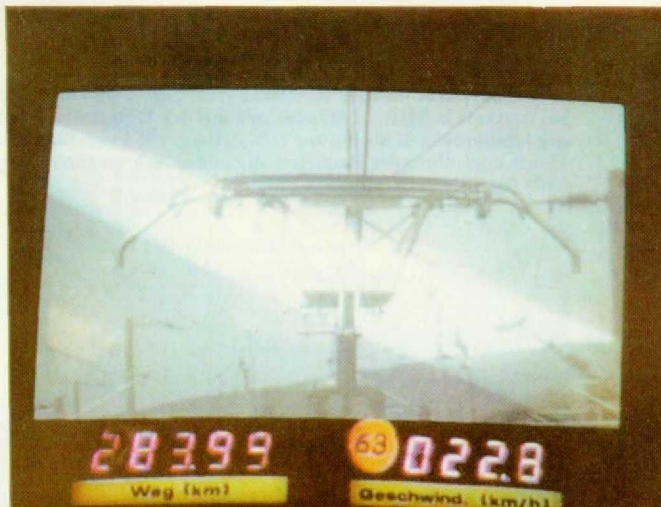
Bild 1. Im Meßwagen zeigt ein Monitor-Bild den Stromabnehmerlauf an der Fahrleitung. Das Foto entstand bei einer Geschwindigkeit von 22,8 km/h; bei hohen Geschwindigkeiten hätte sich der Stromabnehmer für eine Aufnahme zu schnell bewegt.
