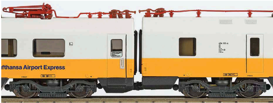
Modellbahn Union: Kuppelabstand mit den serienmäßig eingebauten Schaku-Köpfen
