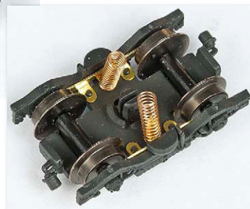
Die Mittelwagen-Drehgestelle haben Schraubenfedern zur Stromübertragung
