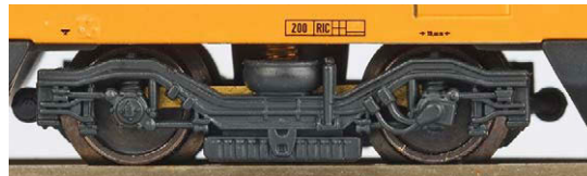
Modellbahn Union: Das Drehgestell des 403 mit Stromführenden Lager-schalen aus Messing für die Radsätze
