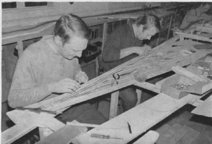
Abb. 2. Clubmitglieder beim Bau einer Weichenharfe für einen unterirdischen Abstellbahnhof (auf der Bundesbahn-Seite). Im Hintergrund ist die auf Styropor-Platten verlegte BEB-Strecke zu erkennen.
