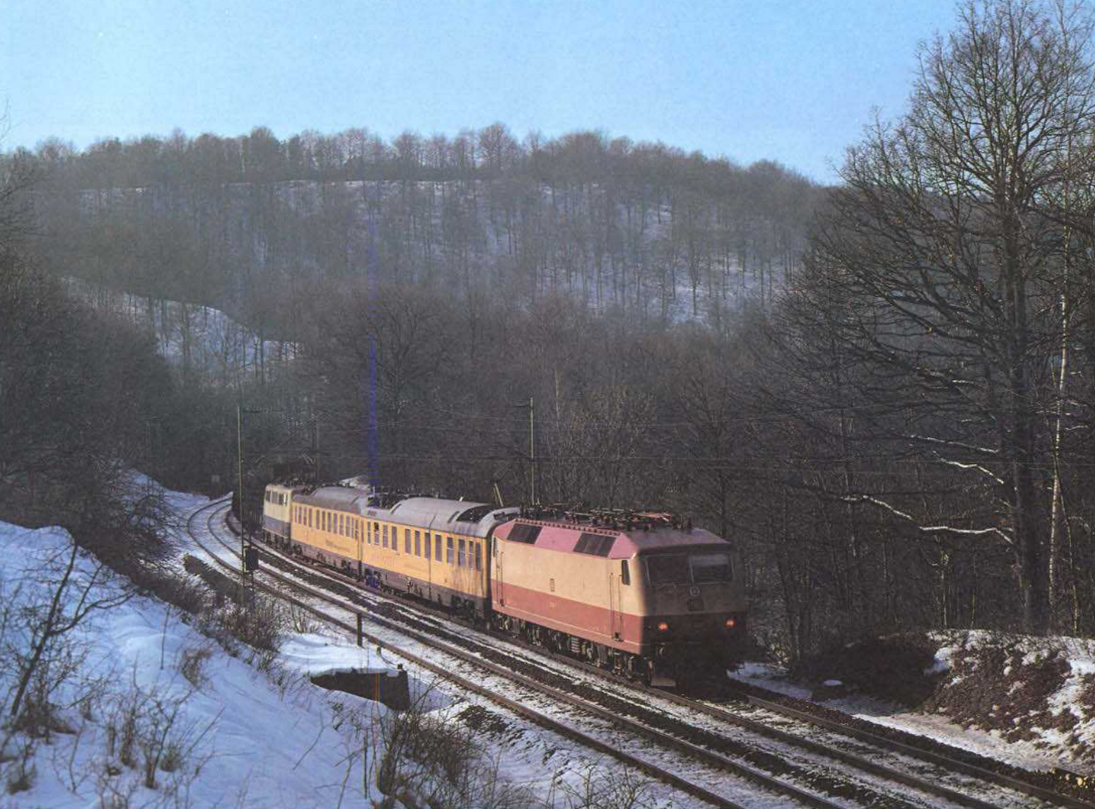
Bild 8: Mit den Lokomotiven der Baureihe 120 wurden bei der DB zahlreiche Versuchs- und Meßfahrten durchgeführt, bevor der Baureihe im Jahre 1984 die Serienreife erteilt wurde. Stellvertretend zeigen wir ein Foto von einer Meßfahrt am 22. 2. 1983 auf der Strecke Ansbach – Würzburg. Der Meßzug bestand aus der 151 045, zahlreichen Güterwagen, der 111 071, zwei Meßwagen und der 120 004. Das Foto entstand in der Nähe von Burgbernheim. Foto: A. Ritz
