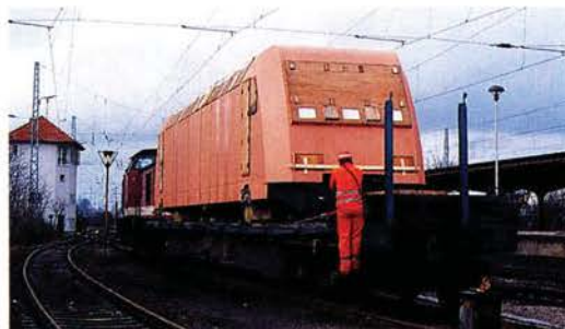
Lokkasten der 101 beim Transport von Hennigsdorf nach Kassel auf einem Güterwagen.
