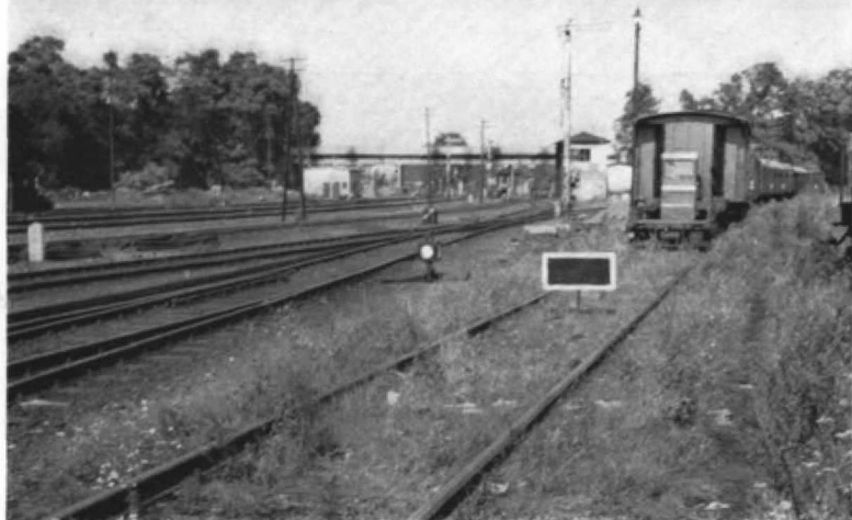
Abb. 1. Schutzhalt-Signal Sh 2 zum Schutz eines abgestellten Bauzuges, der auch im Kleinen solcherart gesichert werden sollte — abgesehen davon, daß die weißumrandete rote Tafel bei einer Farbaufnahme als „roter Farbklecks“ willkommen sein dürfte. (Foto: Ertmer, Paderborn)
