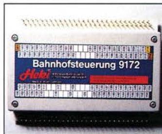
HEKI: Das Modul »Bahnhofssteuerung« ist auf die Steuerung von drei Fahrstraßen ausgelegt. Das Schalten der angeschlossenen Objekte erfolgt nacheinander, so daß eine Überlastung des Versorgungsnetzes ausgeschlossen wird.
