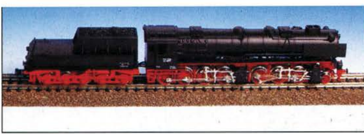
sb-modellbau (N): In der Triebwerksmechanik kaum zu übertreffen ist die Mallet-Lokomotive der Baureihe 53, ein Unikat vom Ende des zweiten Weltkriegs. Limitierte Auflage: 150 Stück.
