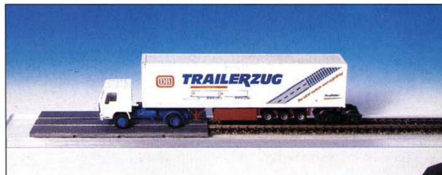
ROCO (H0): Bei der DB erst im Probebetrieb als neueste Variante des Kombinierten Verkehrs sind Trailerzüge aus Sattelauflegern und Eisenbahndrehgestellen.
