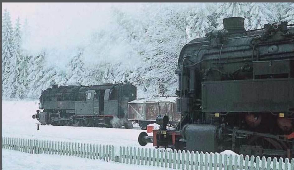
Eine unbekannte 95 mit Neubaukessel des Raw Meiningen auf dem Viadukt im Finstren Grund zwischen Probstzella und Lauscha. Wiederum wird ein Nahgüterzug Richtung Lauscha befördert. Der Viadukt ist ein Stempfbetonbauwerk aus der Zeit vor dem Ersten Weltkrieg, dessen Erhaltung immer erhebliche Probleme bereitete und letztendlich mit ein Grund für die plötzliche Stilllegung der gesamten Strecke am 22. Januar 1997 wurde. Unsere Aufnahme vom 2. Dezember 1973 entstand bei bestem Sonnenschein. Starker Wind hat den Schnee von den umliegenden Bäumen gefegt. Ein hochinteressantes Motiv für den Modellbauer! Anlagen mit Winterszenen wirken oft zuckerbäckerhaft oder kalt und unnahbar. Nadelbäume ohne Schneebedeckung machen sie wieder lebendig. Dass eine solche Situation wirklichkeitsgetreu ist, beweist unser Foto.
