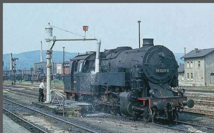
95 020 beim täglichen Wassernehmen in Saalfeld am 2. August 1973. Die Lok trägt geschweißte Wasserkästen, den im Raw Meiningen 1967 gefertigten Neubaukessel Fabriknummer 1330 ohne Speisedom und hat noch alte Zylinder. Der allbekannte Wasserkran – hergestellt im Krausewerk Schafstädt bei Merseburg und inzwischen hellgrau gestrichen – stammt noch aus der Länderbahnzeit.
