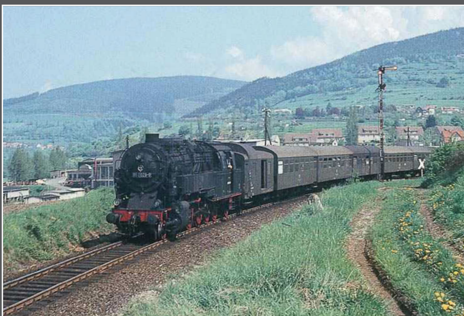
95 020 beim täglichen Wassernehmen in Saalfeld am 2. August 1973. Die Lok trägt geschweißte Wasserkästen, den im Raw Meiningen 1967 gefertigten Neubaukessel Fabriknummer 1330 ohne Speisedom und hat noch alte Zylinder. Der allbekannte Wasserkran – hergestellt im Krausewerk Schafstädt bei Merseburg und inzwischen hellgrau gestrichen – stammt noch aus der Länderbahnzeit.
