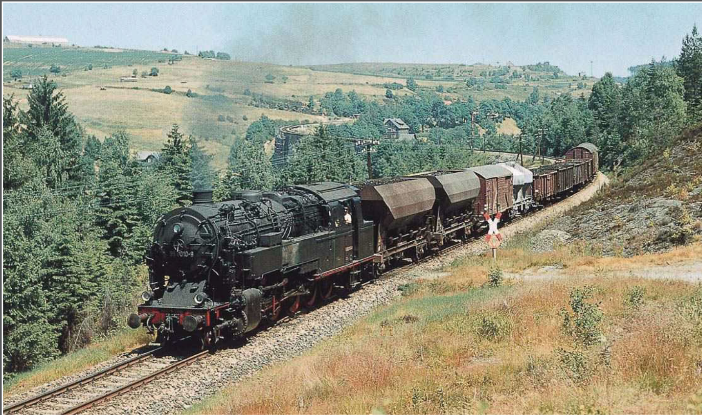
Nebenbahn im Mittelgebirge: Am 23. August 1973 zieht 95 010 ihren Nahgüterzug Richtung Lauscha bei Lichte-Ost. Es fehlt der Speisedom, woran wir leicht den Neubaukessel (Raw Meiningen 1967, Fabriknummer 1331) erkennen. Die Lok ist in gut erhaltenem Zustand, wie fast alle T 20 in jener Zeit. Auch 95 010 besitzt Grauguss-Ersatzzylinder. Im Hintergrund erkennt man den Viadukt von Lichte. Nebenbahn, so wie wir sie uns alle wünschen.
