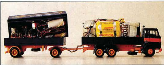
Kein Platz für Zuladung: Das funkferngesteuerte H0-Modell des Mercedes-Lkw ist proppevoll gefüllt mit Empfänger, Batterien, Servos und Antenne.
