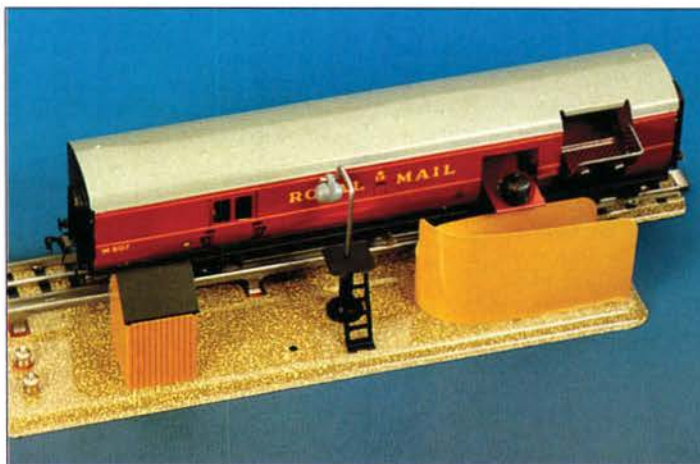
Schnick-Schnack auf englisch: In den 30er Jahren stellte die Firma Märklin in Spur 00 einen Postwagen der Royle Mail her, der aus einem fahrenden Zug einen Postsack in einen Auffangbehälter warf, während er gleichzeitig einen neuen Postsack von einem Gestell abstreifte und aufnahm.
