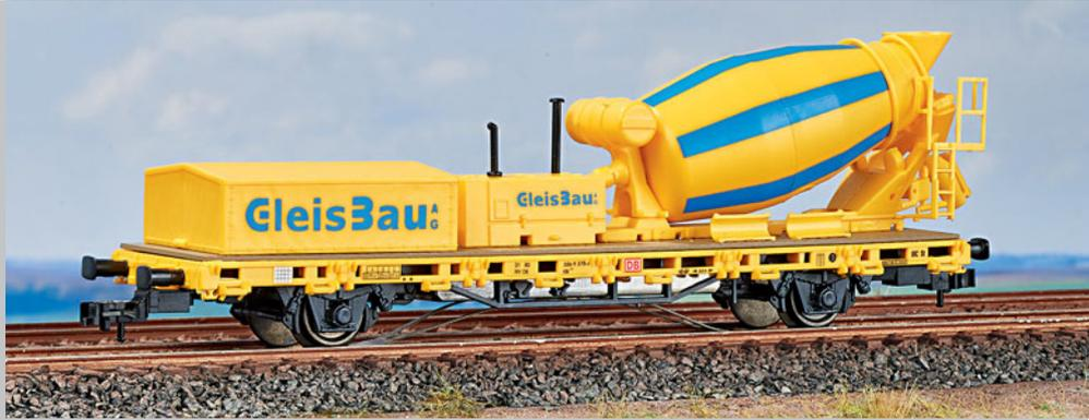
Der Wagen kann mit den Digitalformaten DCC und Motorola betrieben werden, auch im Analogbetrieb dreht sich die Trommel, dann aber immer im Uhrzeigersinn. Wie schon der Robel 54.22 aus der Railmotion-Serie verfügt der Wagen über einen unkonventionellen, aber praxistauglichen Schleifer.
