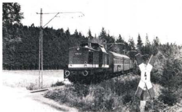
Bild 4 Ausnahmsweise wurde ein Zug mit Diesellok 110 und Rekowagen eingesetzt, um Güter- und Bahndienstwagen von der Strecke nach Schleiz befördern zu können. Der Fahrleitungsmast und das Warnkreuz mit Blitz deuten auf den erst kürzlich eingestellten elektrischen Zugbetrieb hin.
