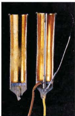
Ein Rauchgenerator besteht aus Tank, Kapillarröhrchen und Heizwendel.
