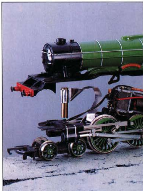
Eine Hornby-Lokomotive mit improvisiertem Halteblech für den Dampfgenerator.
