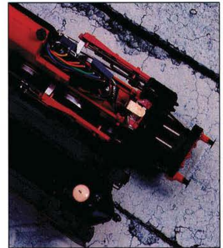
Bei dieser Märklin-Lok wird der Generator von unten in den Schlot eingesetzt.
