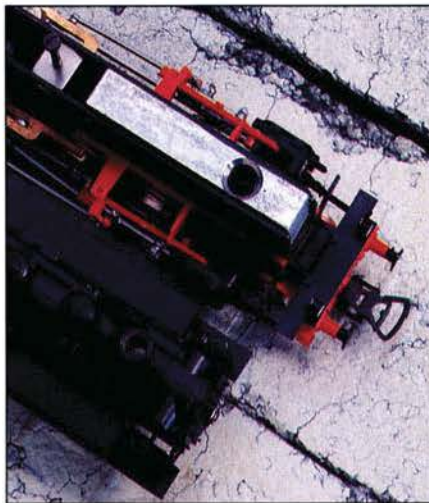
Eine Gützold-Lokomotive mit nachträglich in den Ballast eingebautem Dampfgenerator.
