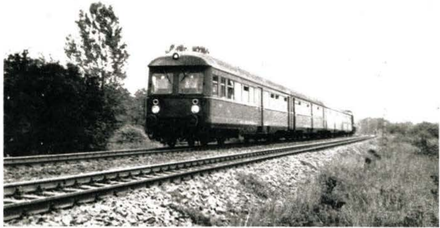
Bild 4 Eingesetzt werden vorerst Wendezüge, bestehend aus 4achsigen Durchgangswagen mit Mittel-einstieg, Baujahr 1952. Als Traktionsmittel werden Elloks der BR 211 und 242 sowie Dieselloks der BR 110 und 118 verwendet. Unser Bild zeigt einen S-Bahn-Zug auf der Strecke von und nach Haldensleben mit einer BR 110.
