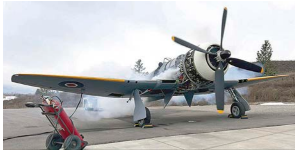
Der Tempest-unübliche R-2800-Sternmotor von Pratt & Whitney beim Testlauf Foto Videofoto über Barrie Stevens
