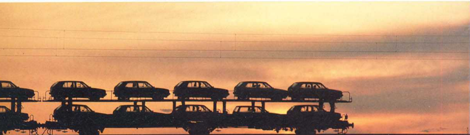
Bild 5: Dem Transport fabrikneuer Personenkraftwagen dienen diese dreiachsigen, zweigliedrigen Doppelstockwagen.
