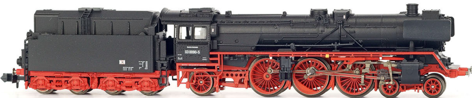
Minitrix: Lokführerseite (oben) und Heizerseite der DR 03.10. Die Pumpen sind auf beiden Seiten unter dem Umlauf platziert
