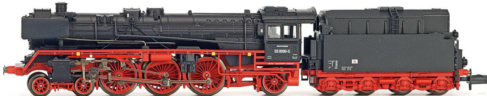
Minitrix: Lokführerseite (oben) und Heizerseite der DR 03.10. Die Pumpen sind auf beiden Seiten unter dem Umlauf platziert
