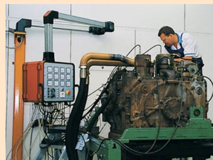
Stolz des Werkes ist der moderne Prüfstand, den jedes ausgelieferte Getriebe passieren muss.
