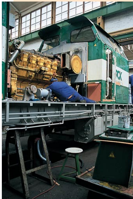
Beim 203-Programm werden auch die Hilfsbetriebe komplett überholt und teilweise ersetzt.
