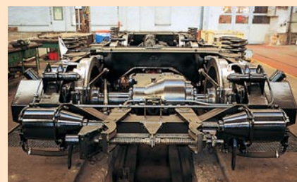
Im Rahmen der Vollmodernisierung erhält eine 203 Drehgestelle mit neuer Sekundärfederung und Lokkastenabstützung.
