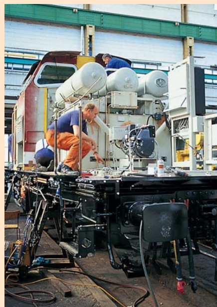
Beim 203-Programm werden auch die Hilfsbetriebe komplett überholt und teilweise ersetzt.
