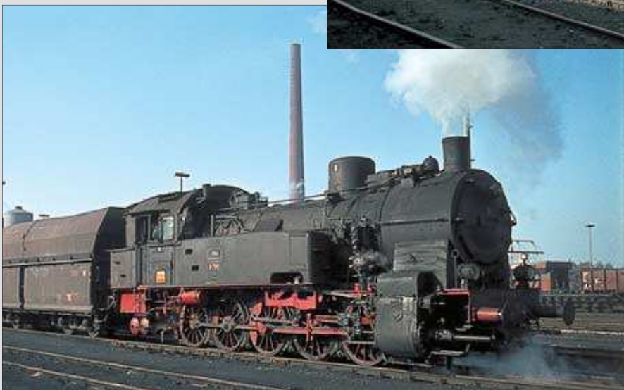
Werkanschlussbahnen verfügten bisweilen über relativ schwere, leistungsfähige Tenderloks: hier D 787 (Krupp 3455/1956) am 27.10.1973 bei Rangierarbeiten auf den Anschlussgleisen der Ruhrkohle AG (RAG) in Grimberg.
