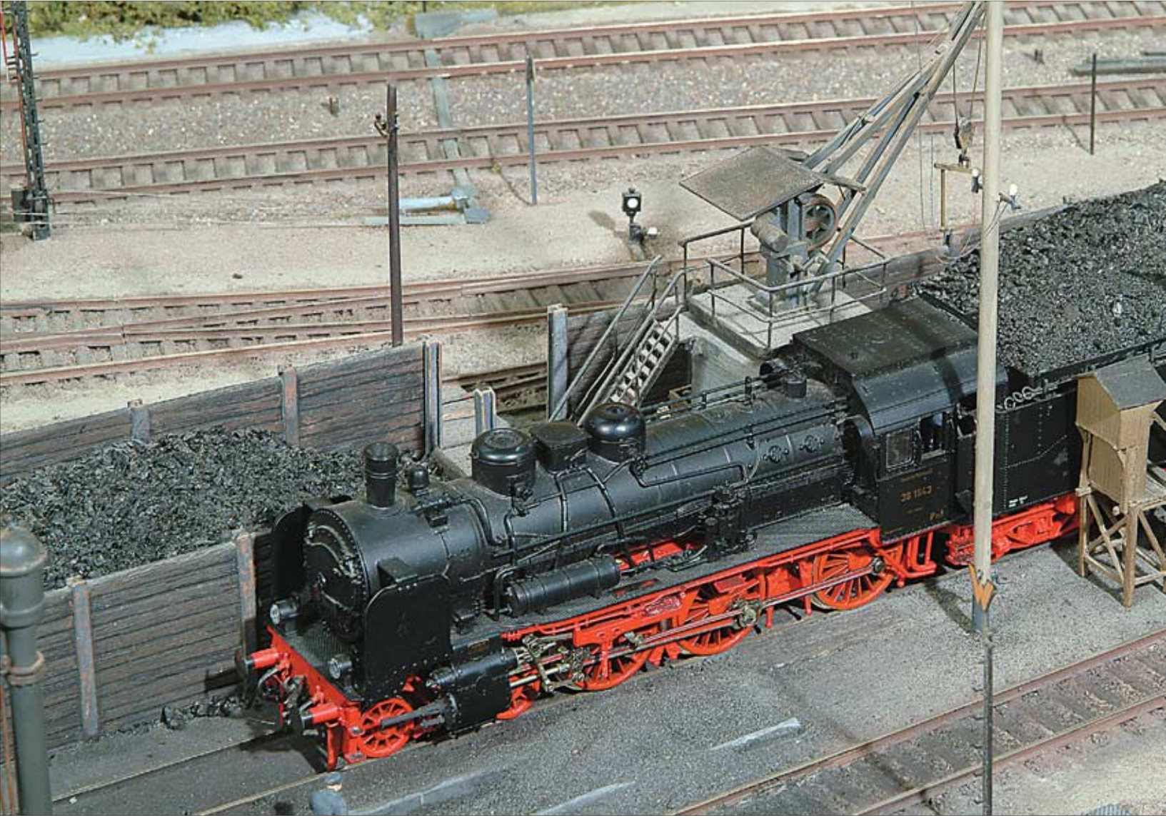
Oben P 8 bei der Einfahrt in die Bekohlungsanlage (nach Anmeldung an der Lokmeldestelle); im Bild links fasst eine T 12 Wasser, im Hintergrund rechts der Schlackenkran.
