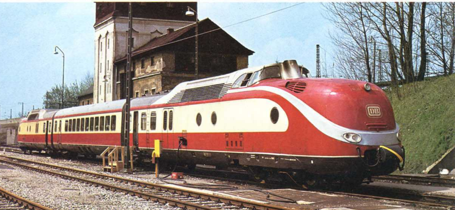
Bild 11: Dieses Foto vom 29. 04. 1980 aus dem Bw München-Ost zeigt, daß beim Vorbild auch Kurzgarnituren mit zwei Triebköpfen und nur einem Zwischenwagen verkehren. Bei der DB war man wohl der Meinung, daß zur Personalschulung für den Einsatz im Turnus- und Charterverkehr eine dreiteilige Garnitur vollauf genügt. Foto: U. Budde
