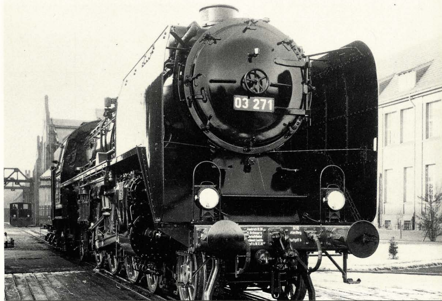
Bild 7: Die 03 271 auf dem Werkhof bei Schwartzkopff in Wildau. Deutlich erkennbar, auch beim Vergleich mit dem oberen Bild, daß die Pumpen nicht mehr in den Rauchkammernischen, sondern in Fahrzeugmitte liegen.
