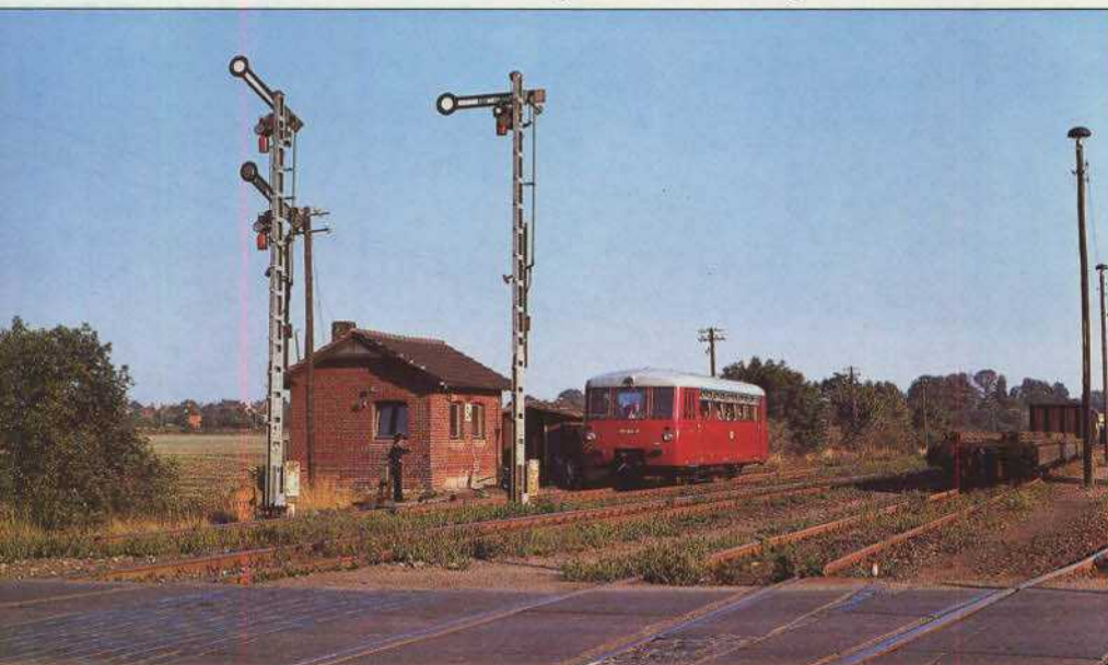
Bild 15: "Freie Fahrt mit Geschwindigkeitsbeschränkung auf 40 km/h" (Signal Hf 2) für den 171 041; der Schrankenwärter lehnt am Kurbelbock und grüßt den Triebfahrzeugführer. Foto: P. Götz
