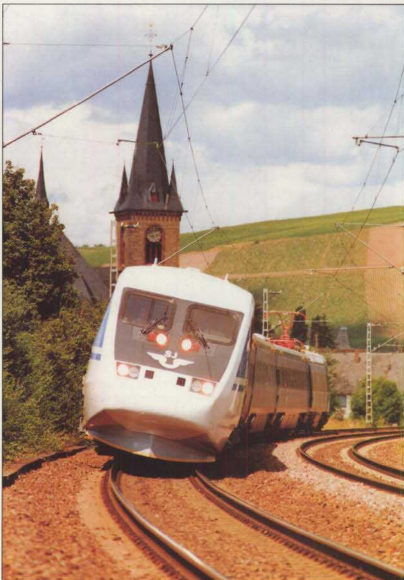
Mehr Tempo in den Kurven! (Seite 42): Mit bis zu 8° Neigung können sich die Wagen des schwedischen X 2000, der im Juli zu Testzwecken auf DB-Gleisen unterwegs war, in die Kurve legen. Die Neigung wird wie beim Pendolino durch ein aktives System bewirkt. Foto: ABB
