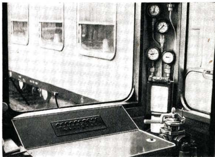
Bild 2 Blick in das Befehlsabteil des Doppelstockwagens. Rechts das Führerbremseventil, dahinter die Halterung für den Buchfahrplan. Über dieser sind die zu Bremsenrichtung und Heizung gehörigen Druckmesser angebracht. Auf dem Befehls-pult sind Schalter und Knöpfe sichtbar. Durch sie werden die Klingel zur Lokomotive, der Sandstreuer, der Scheibenwischer, die Fensterheizung sowie das Schluß- und Spitzensignal bedient.
