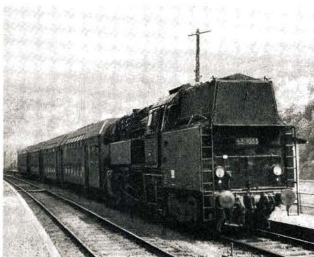
Bild 1 Gesamtansicht des auf der Strecke Schöna - Dresden eingesetzten Wendezuges mit einer Lok der Baureihe 65 10 und einer vierteiligen Doppelstockeinheit.
