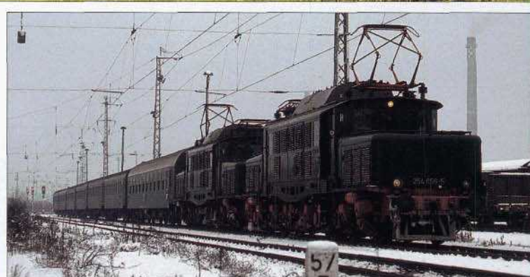
Schnell spricht man hier von Doppeltraktion – es ist Vorspann, denn die Loks sind nicht mehrfach steuerbar. Abb.: Ulrich Graunitz (3)
