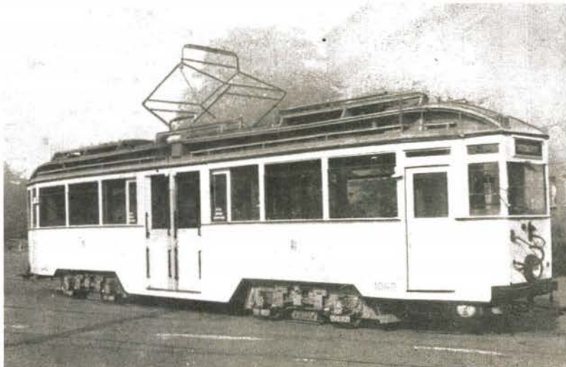
Bild 1 Vierachsiger Mitteleinstieg-Triebwagen Nr. 1040
