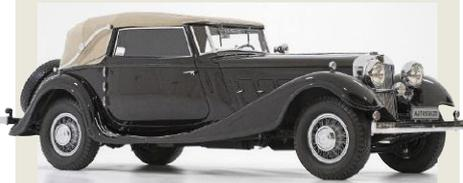
**Horch 670 V** › Er galt 1931 als das revolutionärste Fahrzeug seiner Zeit. Der große Horch verfügte über einen V12-Sechsliter mit hydraulischem Ventilspielausgleich, schaffte 145 km/h und hatte einen fest verbauten Wagenheber, um das knapp 2,5 Tonnen schwere Fahrzeug anzuheben. Preis: 23.500 RM. Die Produktion wurde 1934 nach drei Jahren eingestellt. Nur vier von 80 Fahrzeugen sind erhalten.
