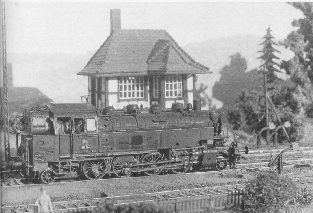
Abb. 4. Das vom Verfasser umgebaute und verfeinerte H0-Modell (Griffstangen, Triebwerk, Armaturen, Führerhausfenster, Pufferbohle usw.) auf Basis der Märklin-86. Die betriebsgerechte Verschmutzung von Lok- und anderen Fahrzeugmodellen war übrigens Gegenstand eines ausführlichen Artikels von Stefan Carstens in MIBA 10/80.
