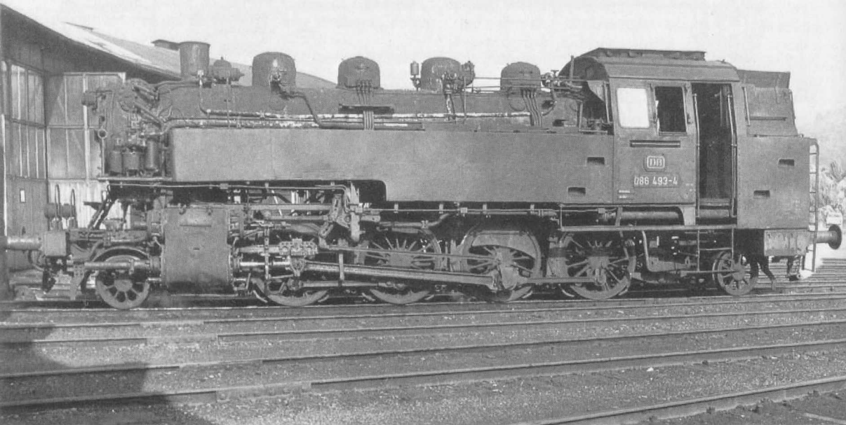
Abb. 12. Die 086 493-4 des Bw Hof, hier im Bw Coburg aufgenommen, hat geschweißte Wasserkästen.
