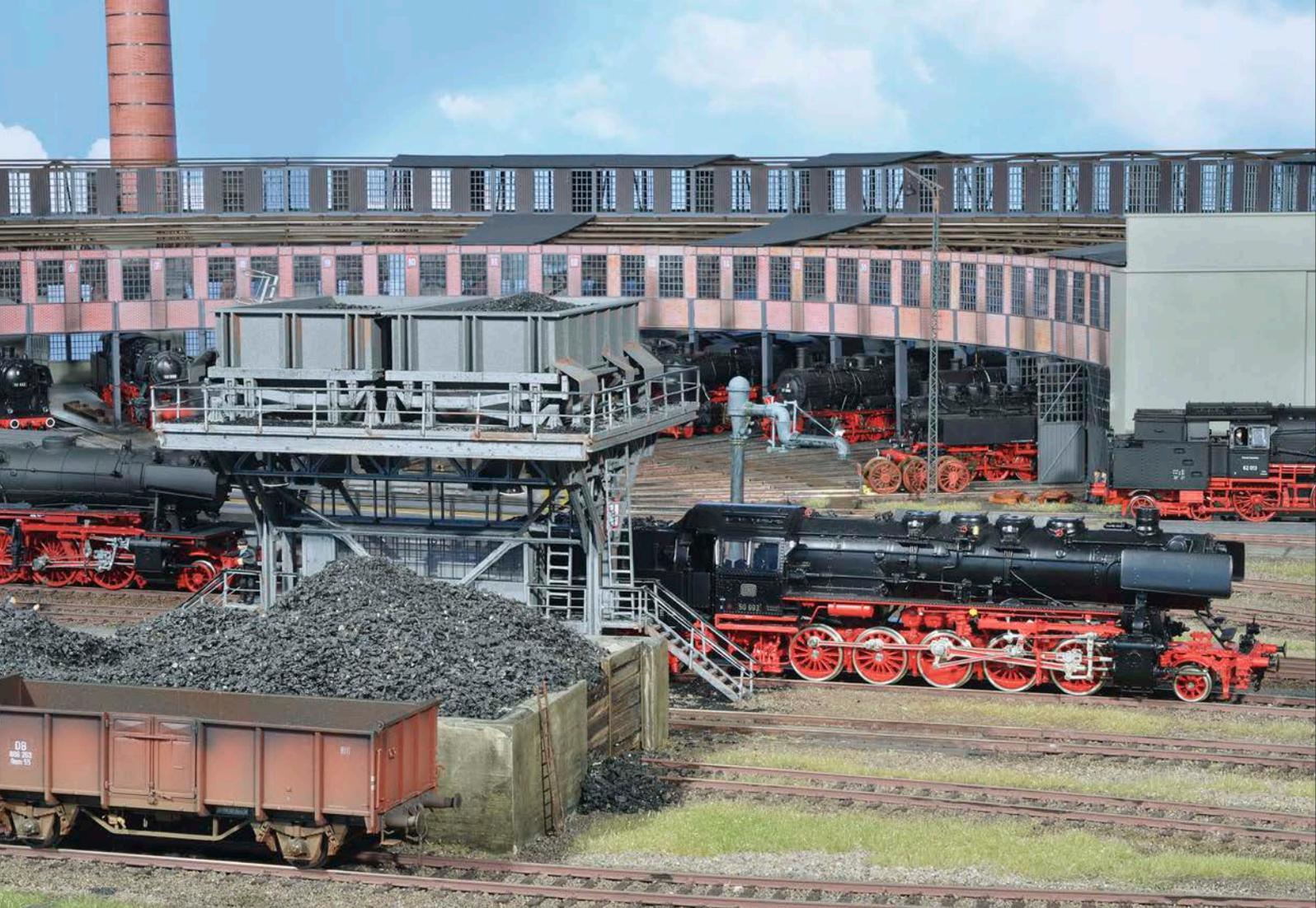
Erste Station ist das Auffüllen des Brennstoffvorrates. Die Kohlen poltern aus einem Hochbunker in den Tender. Bis zur Rückkehr des Kohlenkrans reicht der Vorrat im Hochbunker hoffentlich noch, denn das Schaufeln von Hand wäre doch recht mühsam.
