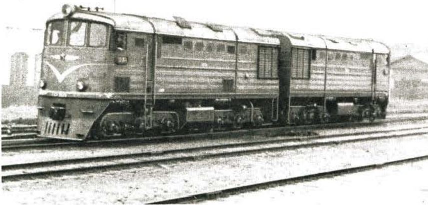
Bild 7 Dieselelektrische Lokomotiven der Reihe „TE-3“ kann man überall auf der Transsib vor Güterzügen sehen
