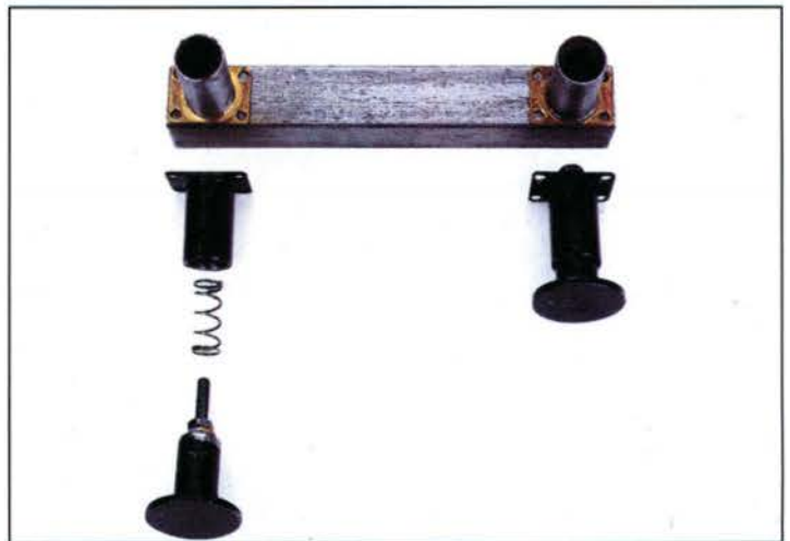
Die Pufferhülsen waren einmal ein 13-mm-Lampenpendelrohr; die Stößel sind von 10 mm dickem Rundstahl abgesägt, und als Teller wurden Unterlegscheiben aufgelötet.
