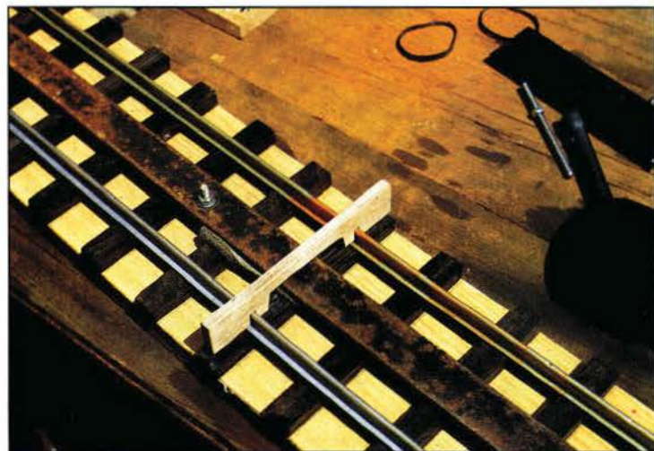
Mit einer Lehre werden Schienen und Schwellen zum Gleisjoch verbunden. Als Schienenmaterial dienen verschrottete Trimetallbleche aus der Offsetdruckerei.
