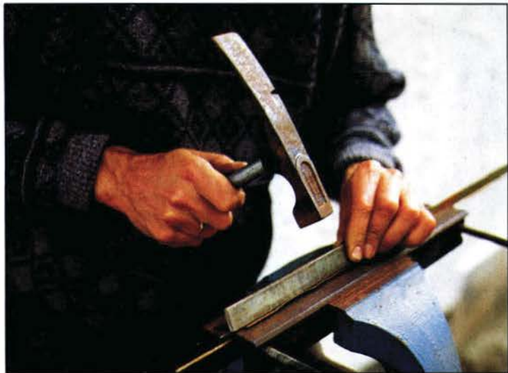
Der Schienenkopf wird von einer Lehre aufgenommen, die auch die Steghöhe bestimmt. Das gewalzte Blech wird gespreizt und zum Fuß abgewinkelt.
