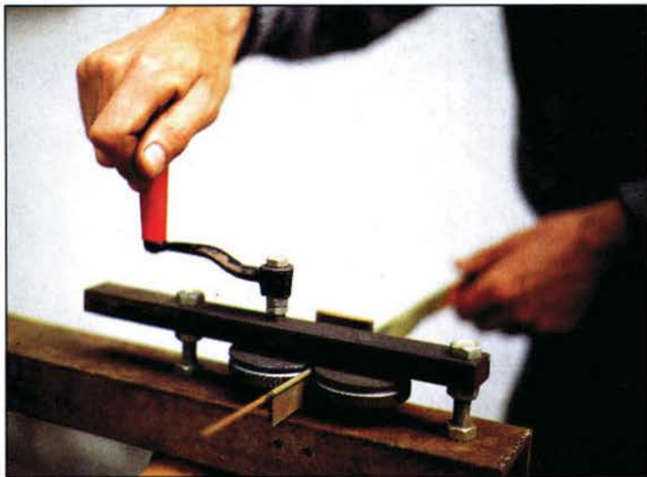
Die Schienenproduktion hat Hans-Joachim Maruhn durch den Eigenbau einer Rollvorrichtung mechanisiert: Kopf und Steg der späteren Schiene entstehen.
