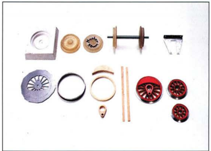
Eine weitere Abteilung in Maruhns Radsatzwerkstatt ist die Gießerei. Eine Gipsform nimmt das Gießharz auf. Der erstarrte Rohling wird bearbeitet und schließlich mit seinem Zwilling und der Achse zum Lauf- (oder Wagen-)radsatz komplettiert.
