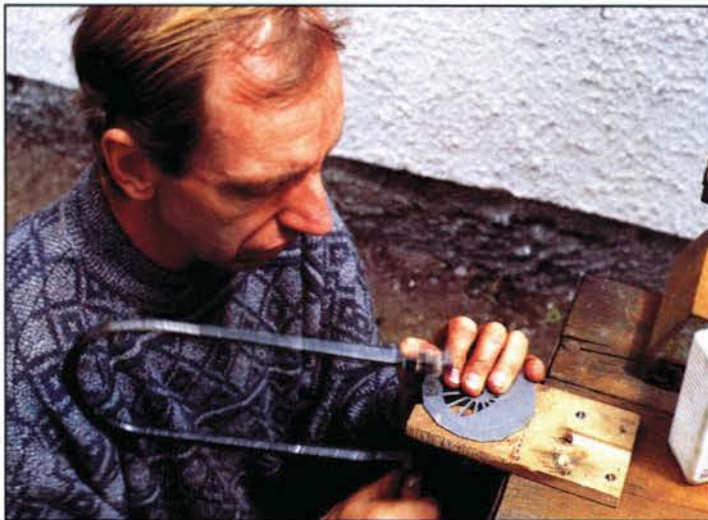
Anreißen, anbohren, dann wird das 2-mm-Stahlblech mit der Laubsäge zur Radscheibe ausgeschnitten. Es folgen das Absägen des Radreifens von einem Stahlrohr sowie das Zusammenlöten beider Teile. Gegengewicht und Speichen aus Sperrholz werden eingeklebt.
