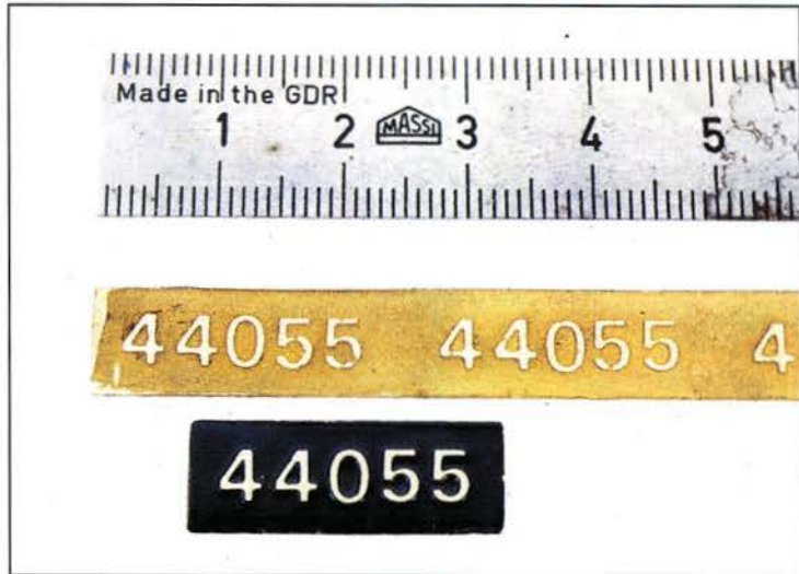
Nummernschilder, gefertigt aus Messingblech mit normalem Leiterplattenätzmaterial.
