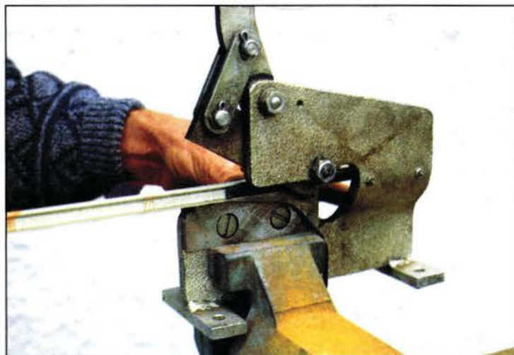
An einem angepunkteten Anschlag entlanggeführt läßt sich die Schienenfußbreite exakt, bequem und rasch zuschneiden. Zeit für die 600 mm lange Schiene: knapp 3 min.
