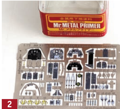
2 Die Ätzteile vor dem Bau mit Klarlack fixieren (verhindert Abplatzen der Farbe).
