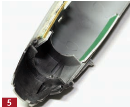
5 Für das Seitenleitwerk und die Kielflosse wurde Plastiksheet als Basis eingeklebt.
