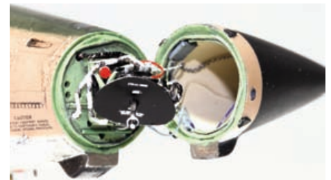
Das R14 Radar im aufgeklappten Radom.
