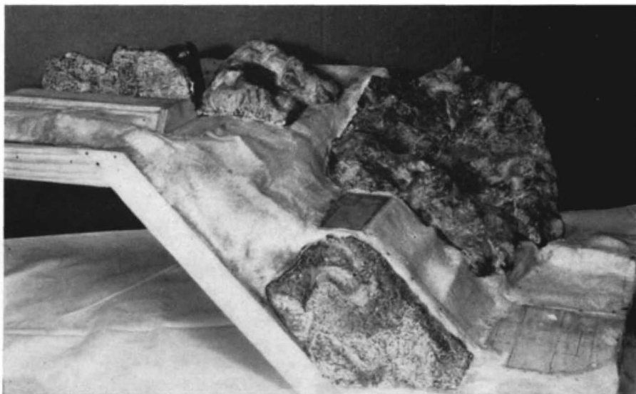
Abb. 3. Die Drahtgaze-Flächen sind hier bereits (wie im Text erläutert) „beschichtet“ und auch die Übergänge zu den Felsen schon vormodelliert. Die Fundament-Auflageflächen sind freigehalten.
