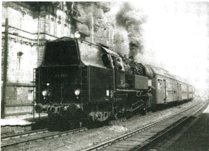
Bild 1 Wenzelzug mit einer Dampflokomotive der BR 65 im Bf Schöna. Zu der Zeit, als dieses Bild entstand (1974), war die Strecke Dresden-Schöna noch nicht elektrifiziert.
