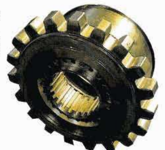
Bild 10: Zahnrad für Einlamellen-Zahnstange nach System Strub mit Brennstrommel. Abb.: B. Moser
