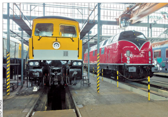
■ Bei den Netinera-Werken entstand für die SGL-Schienen-Güter-Logistik GmbH aus dem Innenleben inklusive Motor der 232 446 und dem Rahmen der 232 387 des ehemaligen Abenteuerzuges Kratzburg eine neue Lok. Rechts neben ihr steht die Netinera-Werklok 221 145, eine der ehemaligen Griechenland-Loks.
